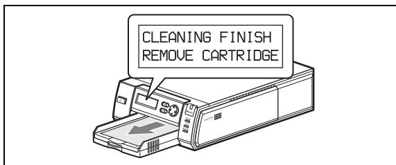
**7** Retirez la cassette de nettoyage de l'imprimante et réinsérez la cartouche d'impression dans le bac à papier.
